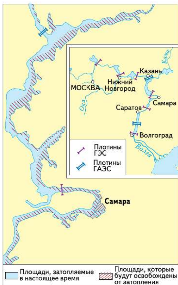
Рис. 97. Проект перестройки Волжского каскада ГЭС
